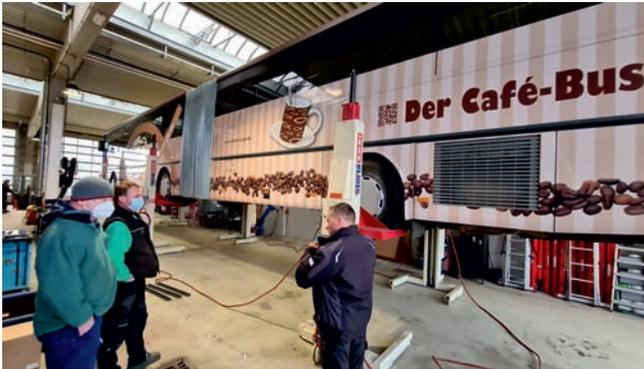
Und für das Team ist es immer wieder spektakulär, wenn die sechs Radgreifer-Hebebühnen platziert werden und den 18 Meter langen und über 14 Tonnen schweren Bus auf Arbeitshöhe anheben.
